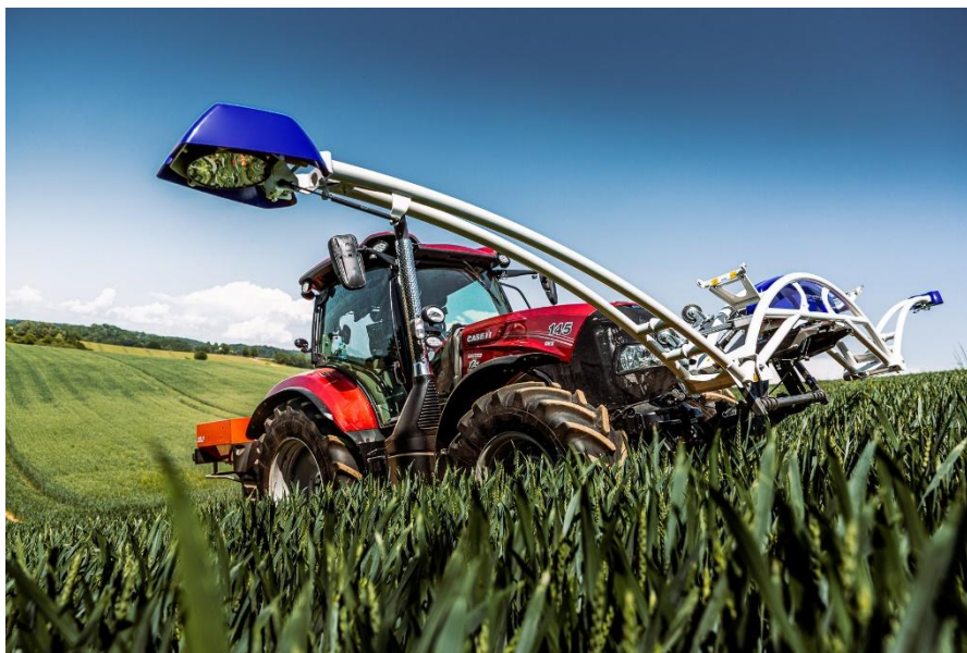
Slika 5.31. ISARIA senzor za praćenje stanja biljaka
