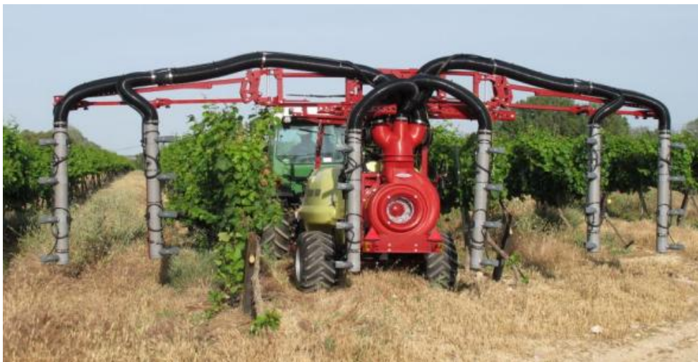
a) raspršivač „CRONOS VARIA“ HARDI s centrifugalnim ventilatorom
