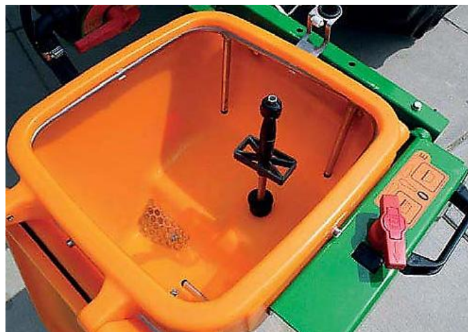
Slika 3.259. Spremnik za pripremu s Vario sklopkom za ispiranje i razblaživanje
