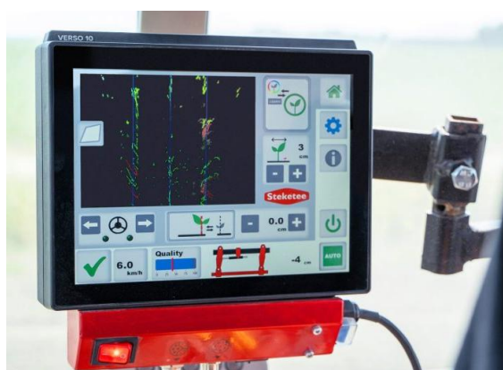
Slika 5.17. Prikaz detekcije korova korištenjem Steketee IC kamere (Izvor: https://www.profi.co.uk/news/camera-for-improved-weed-detection/ )
