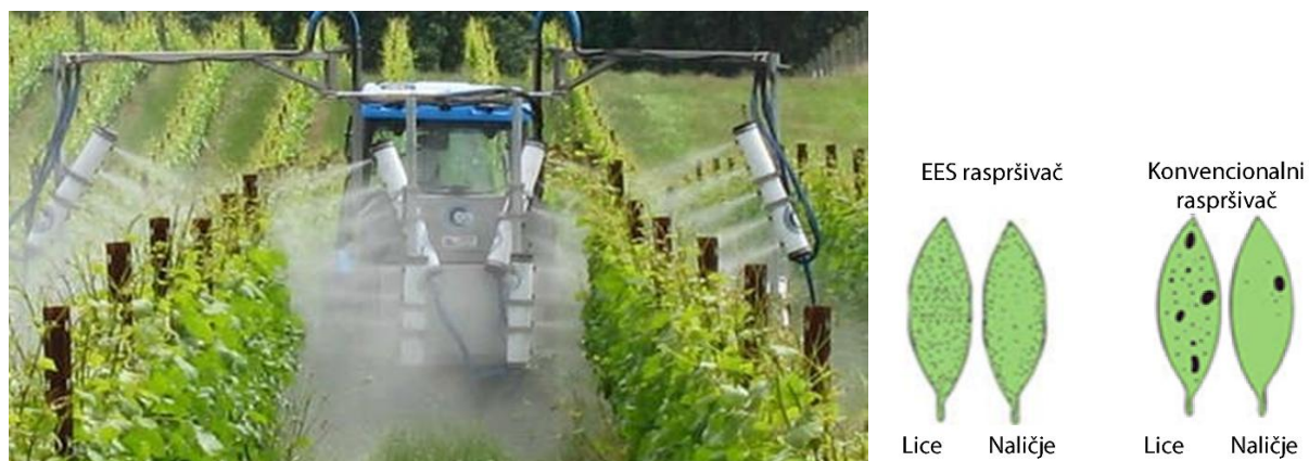
Slika 4.3. Prikaz elektrostatičkog orošavanja (Izvor: Malešević, 2018)
