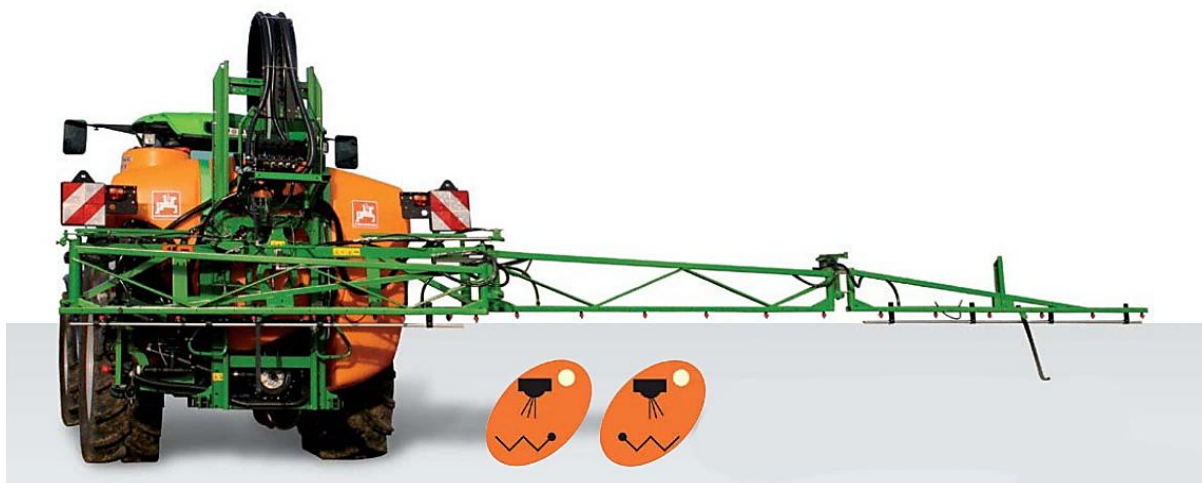
Slika 3.123. Jednostrano sklapanje prskajućih krila
