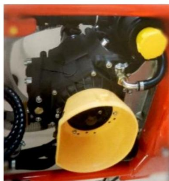
b) tro klipno-membranska crpka PA 930 „Agromehanika“
