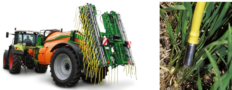
Slika 3.135. Snop povlačnih cijevi za tekuća gnojiva
