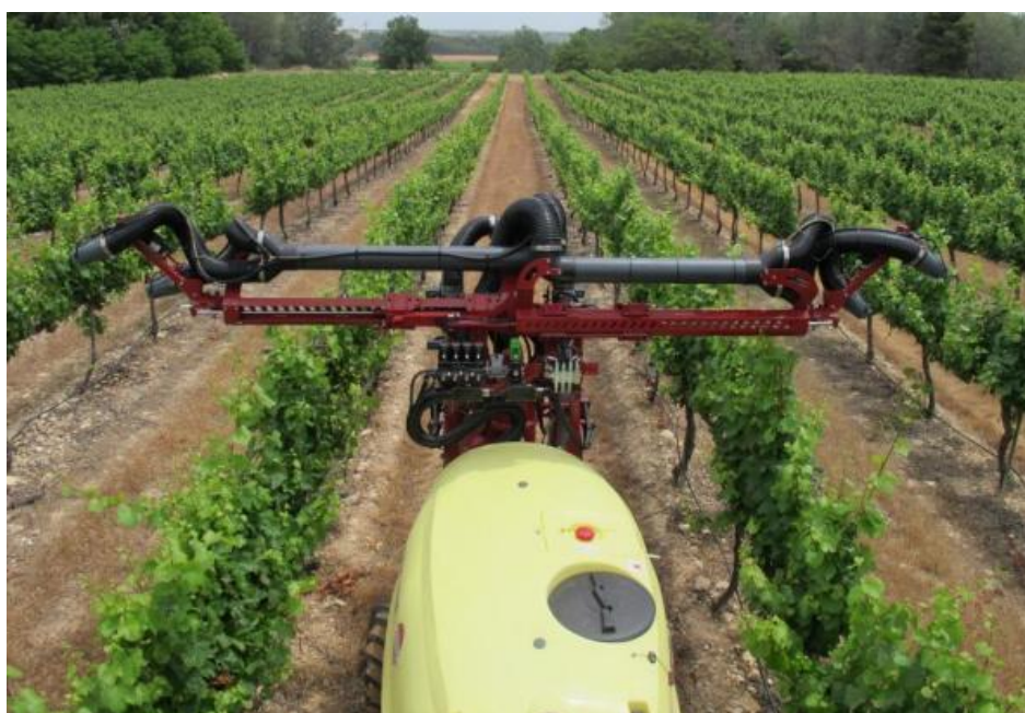
b) raspršivač „BOXER“ HARDI s centrifugalnim ventilatorom
