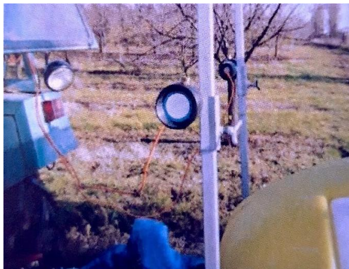
Slika 4.145. Ultrazvučni senzor (Izvor: Sedlar, 2014)
