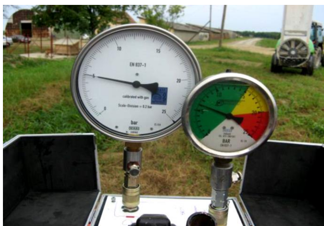
Slika 3.295. Uređaj za mjerenje ispravnosti manometra i quantometra (Izvor: Krišto, 2015)
