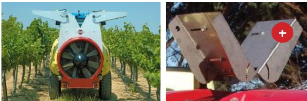
Slika 4.97. Izvedba usmjerivača na raspršivačima za vinograde i voćnjake, Duo „V“ za vinograde (desno) i Duo „T“ za vinograde (lijevo)
