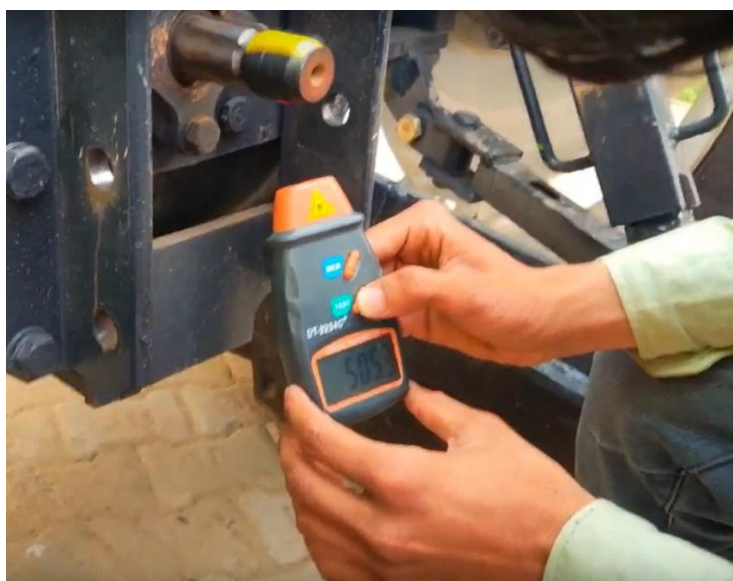
Slika 3.294. Mjerenje broja okretaja pomoću tahometra
