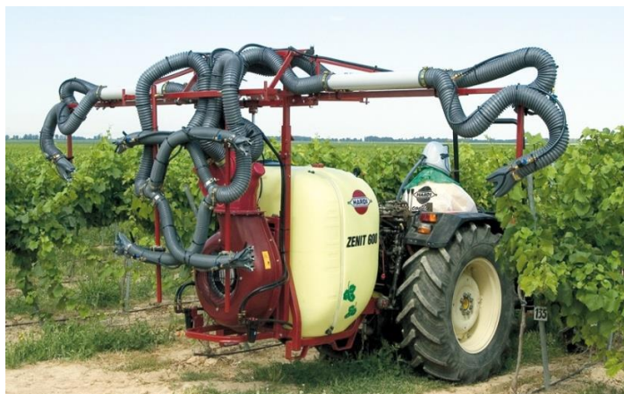
Slika 4.48. Ovjesni raspršivač u zaštiti vinograda (Izvor: https://www.hardi-international.com )
