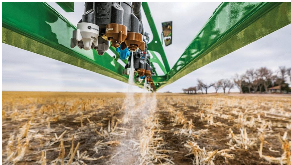
Slika 5.22. Aplikacija kemijskog sredstva na određenim mlaznicama (Izvor: https://www.deere.com/en/sprayers/see-spray-select/ )
