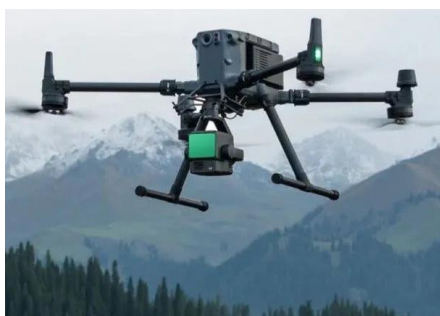
Slika 5.6. Zračno lasersko skeniranje - metoda snimanja preciznih 3D podataka terena pomoću laserskih impulsa
