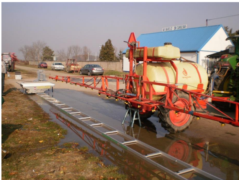
Slika 3.297. Mjerenje poprečne raspodjele tekućine s uređajem Spray scanner (Izvor: Patković, 2014)
