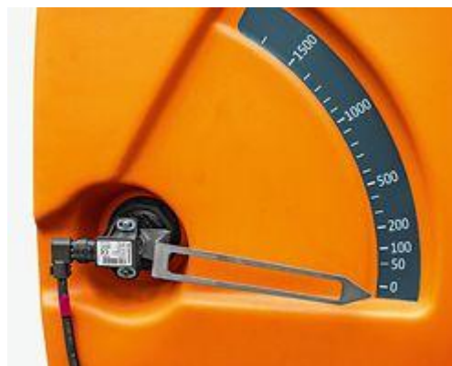
Slika 3.257. Glavni spremnik prskalice UG i pokazivač razine tekućine
