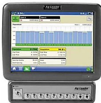
Slika 5.27. Kontrolni monitor za nadzor rada i upravljanje priključcima (Izvor: Sito i sur., 2015)
