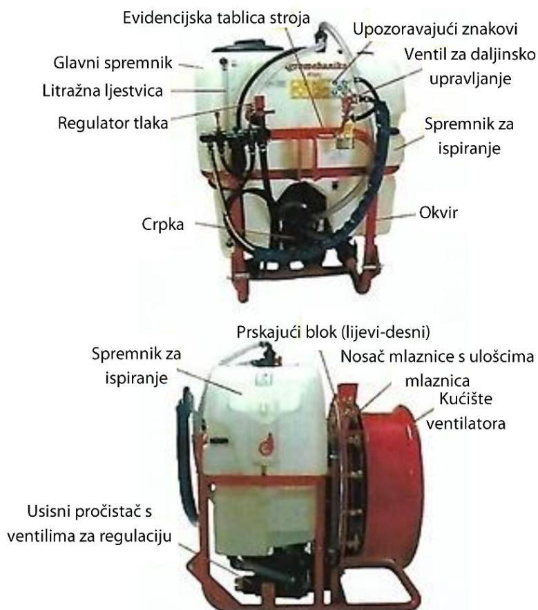
Slika 4.22. Sastavni dijelovi ovjesnog raspršivača AGP 300 EN
