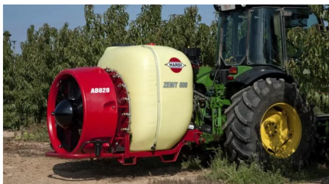
Slika 4.49. Ovjesni raspršivač s aksijalnim ventilatorom (Izvor: https://hardi.com/en/sprayers/mistblowers/zenit )
