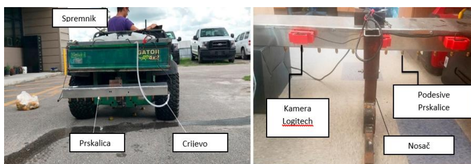
Slika 5.11. Uređaj za aplikaciju zaštite postavljen na radno vozilo (Izvor: Partel i sur., 2019)
