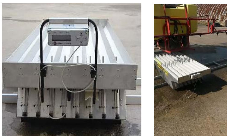
Slika 3.298. Uređaj za ispitivanje horizontalne raspodjele tekućine Spray scanner (Izvor: Patković, 2014)
