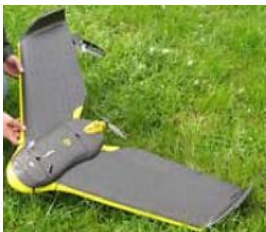
Slika 5.28. Bepilotni sustav Sensefly eBeeAG (Izvor: Sito i sur. 2015)
