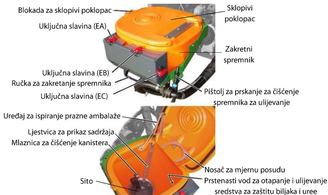
Slika 3.94. Zakretni spremnik za ulijevanje ili usipavanje zaštitnog sredstava
