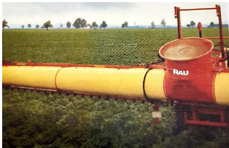
Slika 3.235. Ventilator na prskalici sa zračnom potporom (Izvor: Juras, 2006)
