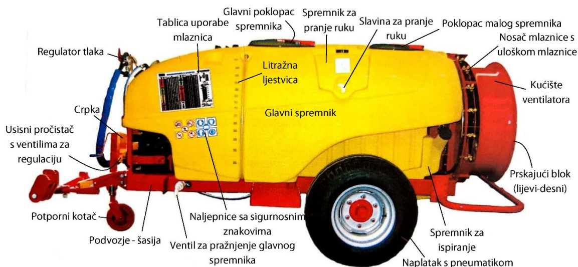
Slika 4.56. Glavni radni dijelovi vučenog raspršivača
