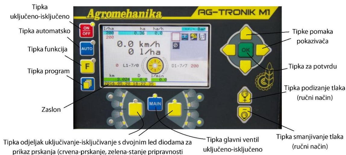
Slika 3.54. Elektronski uređaj AG-TRONIK 14 (Izvor: https://agromehanika.si/product/ag-tronik-14-shop )
