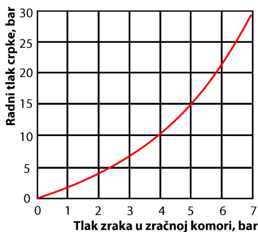
Slika 4.89. Dijagram zraka u zračnoj komori u odnosu na radni tlak crpke
