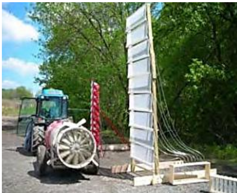
Slika 4.148. Vertikalni pokretni Spray-Skener (Izvor: Sedlar, 2008)
