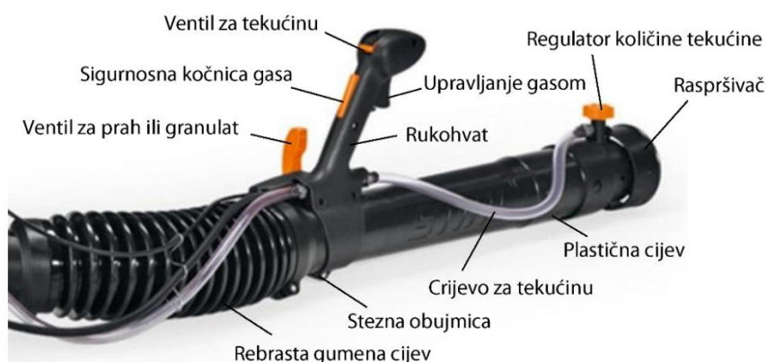
Slika 3.21. Sklop za prskanje (Izvor: original)
