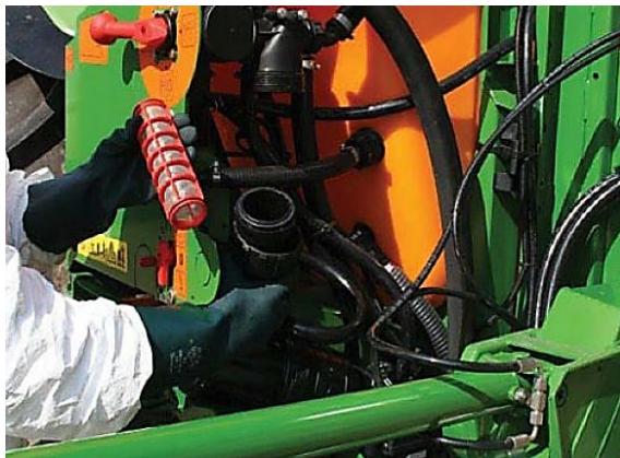
Slika 3.102. Samočišćeći pročištač – filteri tlaka
