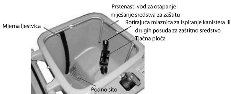
Slika 3.261. Funkcijski elementi u spremniku za pripremu tekućine
