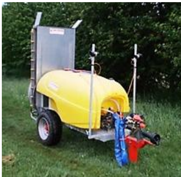
Slika 4.144. Raspršivač za selektivnu aplikaciju (Izvor: Sedlar, 2014)
