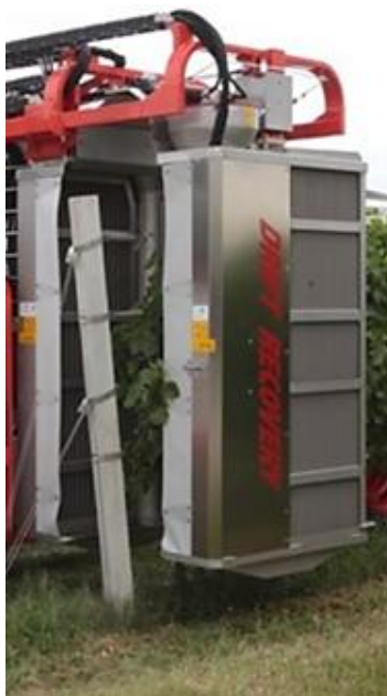
Slika 4.141. Vertikalna lamelasta ploča za prihvat kapljica tekućine koje se nisu zadržale na biljci (Izvor: https://www.agricolmeccanica.it/en/prodotti/drift-recovery-vver-600/ )
