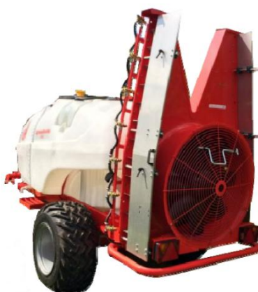
Slika 4.96. Raspršivač s aksijalnim ventilatorom i okomito postavljenim podešivim mlaznicama po visini
