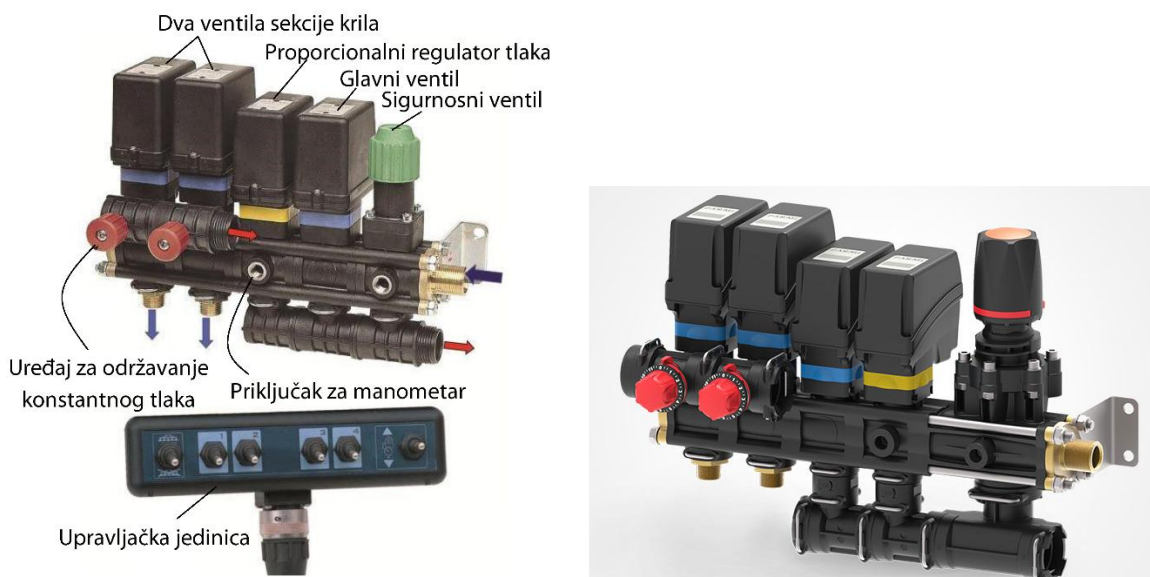
Slika 3.185. Suvremeni mjerno-regulacijski sklop (Izvor: https://www.ppv-fachhandel.de/arag-serie-863/ppv-000261 )
