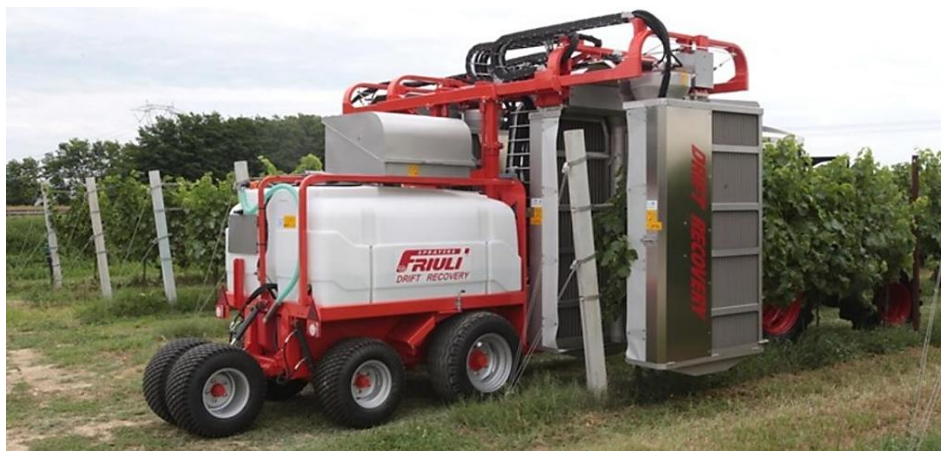
Slika 4.140. Tunelski raspršivač Agricolo Meccanica Drift Recovery (Izvor: https://www.agricolmeccanica.it/en/prodotti/drift-recovery-vver-600/ )
