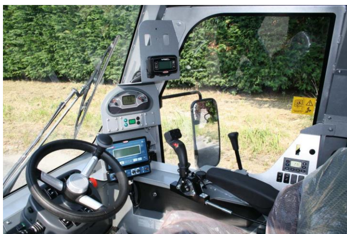
Slika 4.136. Unutrašnjost kabine s uređajima za upravljanje i regulaciju rada raspršivača (Izvor: https://www.andreoliengineering.it/atom-2000-hp/?lang=en#iLightbox[gallery_image_1]/4 )
