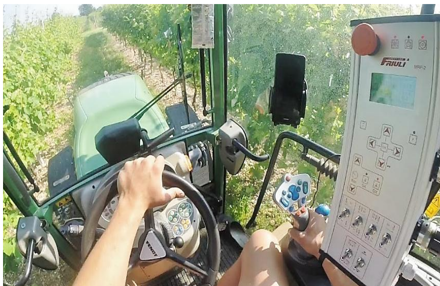
Slika 4.143. Upravljački sklop u kabini traktora (Izvor: https://www.youtube.com/watch?v=sUmmmpoump54 )
