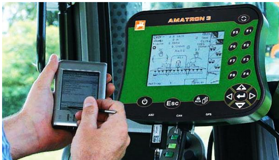
Slika 3.275. Izrada dokumentacije s ASD-om
